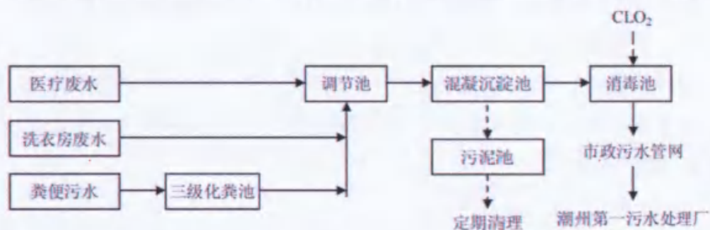
图 4-1 医疗废水处理工艺流程图
